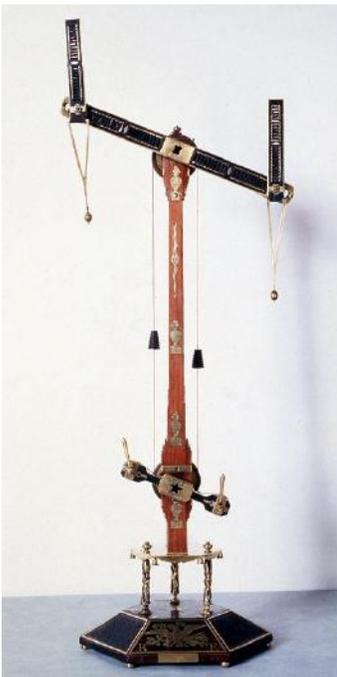
La machine est constituée d'une poutrelle de 4 mètres de long, le régulateur fixé au milieu du mât et pouvant être mis à l'horizontale, en oblique à la verticale. A ses extrémités, deux barres d'un mètre de long appelées ailes peuvent, par leur mobilité autour d'un axe, prendre un certain nombre de positions.
